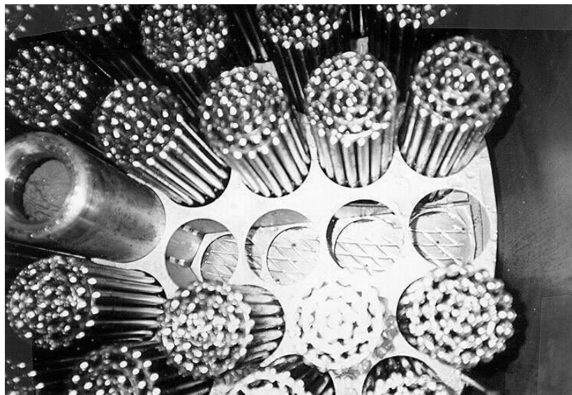
Figura 4.4 - Detalhe interno do recipiente com combustível nuclear queimado Fonte: INVAP, 2004
