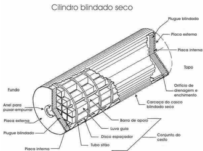
Figura 3.19 - Cilindro de armazenagem interno ao silo horizontal
