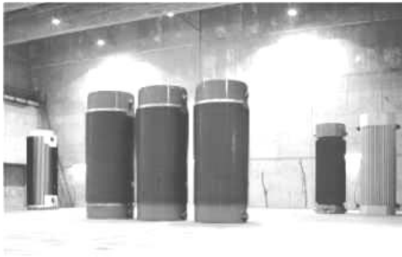
Figura 4.2 Cascos metálicos para armazenar CNQ em Gorleben, Alemanha Fonte: http://www.gkn.de
