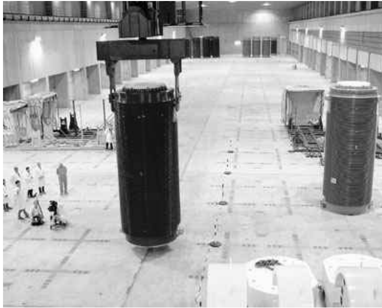
Figura 4.1 - Interior da instalação de Gorleben, Alemanha, onde se vê cascos com CNQ Fonte: http://www.gkn.de
