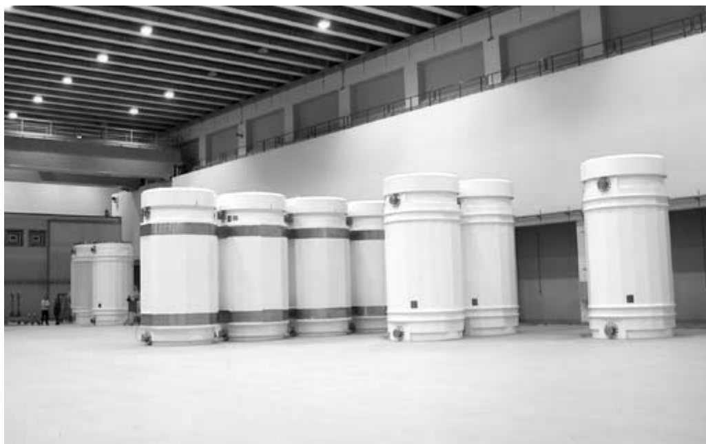
Figura 4.20 - Cascos de aço com CNQ dentro da instalação ZWILAG, Suíça Fonte: http://www.zwilag.ch (2004)
