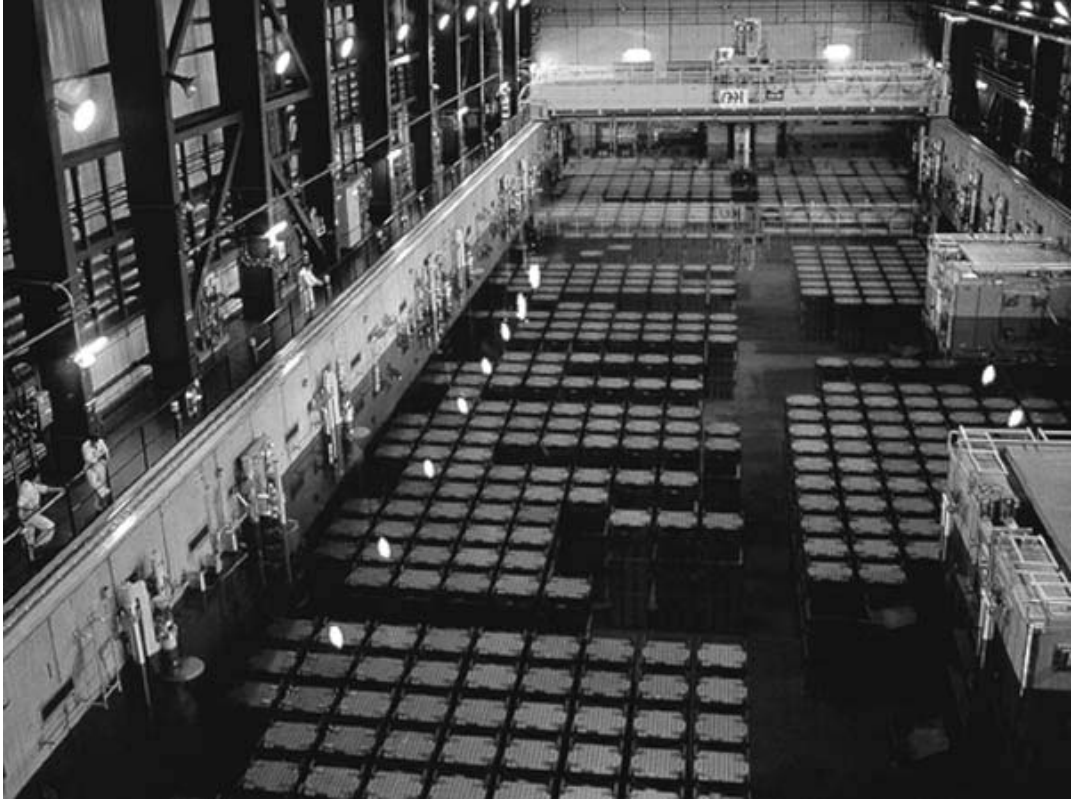
Figura 4.11 - Instalação centralizada de armazenagem de CNQ em via úmida, La Hague, França
