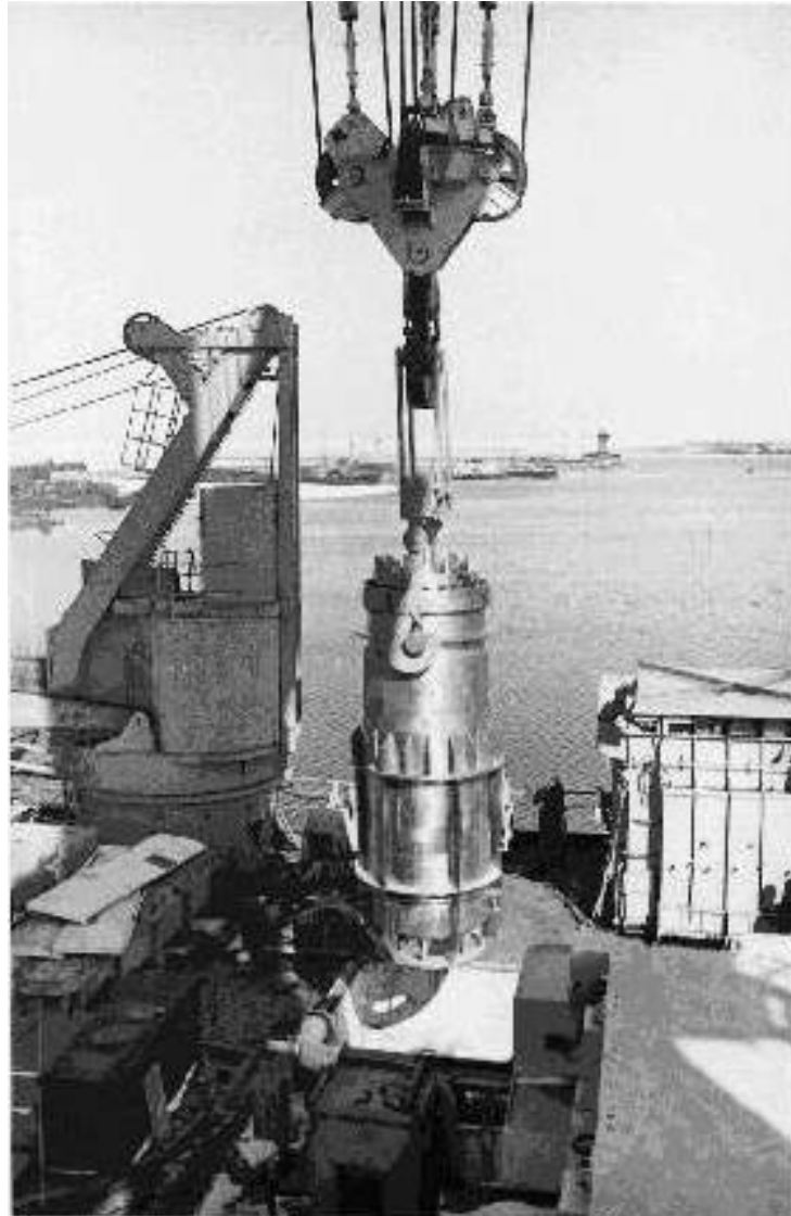
Figura 3.26 - Introdução de um casco com CNQ no navio transportador russo.
