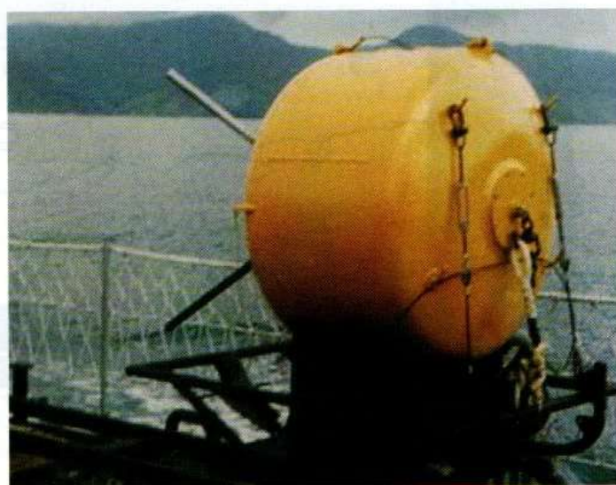
Mina de fundeio e contato desenvolvida pelo IPQM
