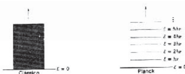
Fig. 3 – Diagrama dos níveis de energia de um oscilador simples (à esquerda) e de um oscilador simples que obedece a hipótese de Planck (à direita). Fonte: Eisberg (1979)
