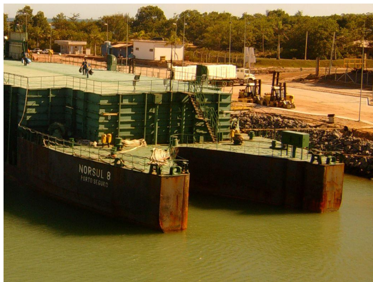
Figura 2.2.1 – Reentrância na popa da Barcaça para acoplamento.
