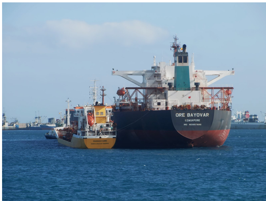
Figura 8 - Navio petroleiro Guanarteme atracado à contrabordo do graneleiro Ore Bayovar realizando a operação de bunkering na cidade de Las Palmas, Espanha
