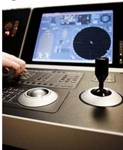
Figura 4: Mesa de controle DP
