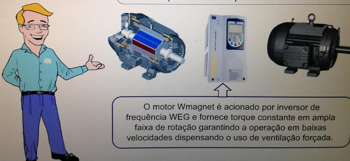
O motor Wmagnet é acionado por inversor de frequência WEG e fornece torque constante em ampla faixa de rotação garantindo a operação em baixas velocidades dispensando o uso de ventilação forçada.
