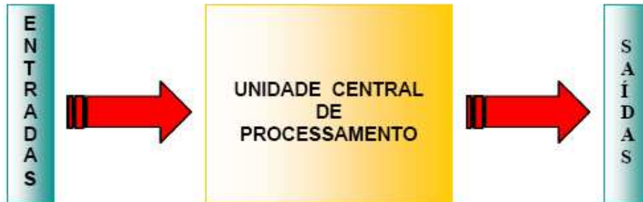
Figura 1 - Estrutura básica de um CLP
