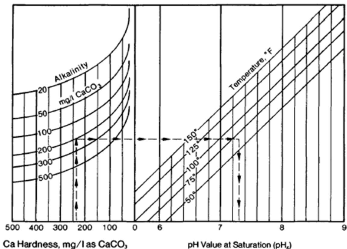
**FIGURA 02:** Diagrama mostrando os passos para obtenção do valor de pHS. No exemplo: dureza Cálcio = 240 mg/L; Alcalinidade total = 200 ppm; Temperatura = 70°F; PH de saturação (pHS) = 7,3.
