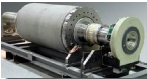
Fig. 6: Motor Síncrono com material supercondutor em alta temperatura
