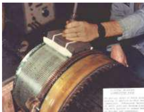
Fig. 16 Deposição de liga de níquel nas teclas de um coletor
