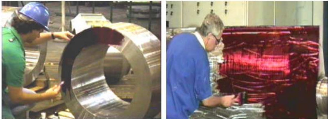
Aplicação do líquido penetrante com pincel (figura I).
