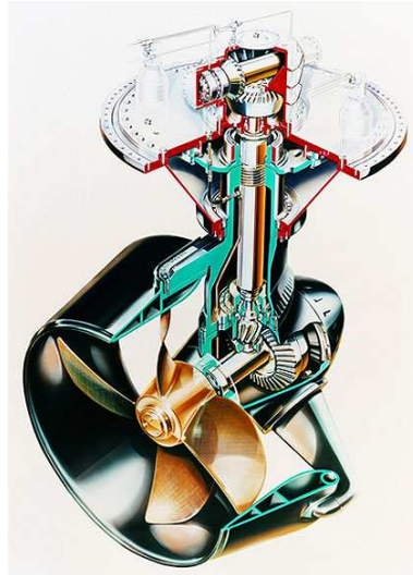
Fig. 10 – Sistema de propulsão Schottel
