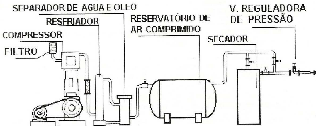
Fig. nº 4 – Esquema do sistema de produção e tratamento de ar comprimido. (Fonte: BRASIL. Diretoria de Portos e Costas. Ensino Profissional Marítimo. Princípios de Automação de Processos; Princípios de Automação de Comandos. Rio de Janeiro: 1995. p. irreg. Curso de Aperfeiçoamento Vol.6.).
