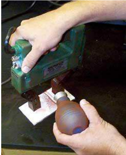
Figura 13 Aplicação em via seca
