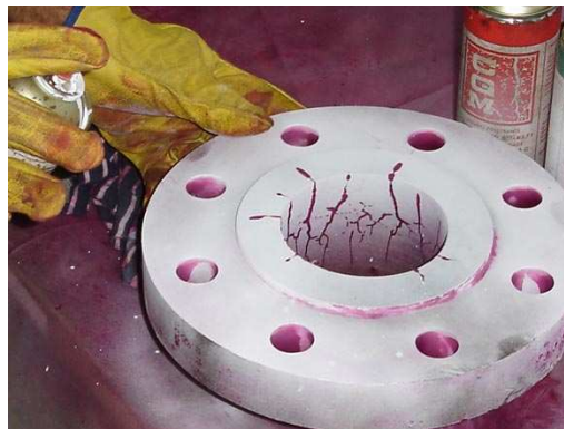
Figura 6 Revelação de descontinuidade sob luz branca
