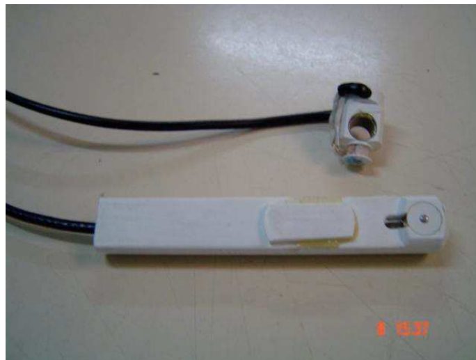
Figura 8 Fotografia das Duas Sondas Tipo “Caneta”, em Arranjo Diferencial.
