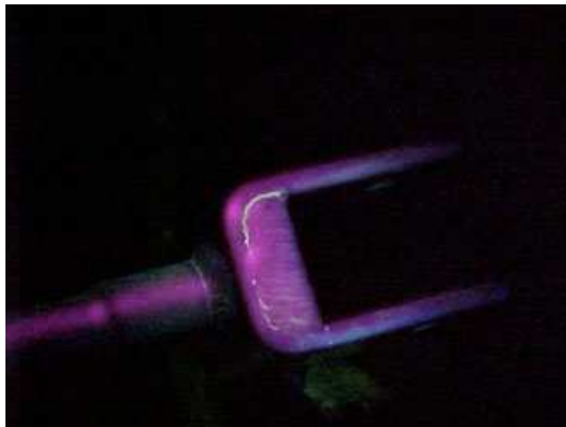
Figura 5 Revelação de descontinuidade sob luz negra
