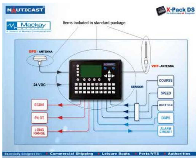
Figura 3 – Exemplo de equipamento AIS a ser instalado a bordo.
