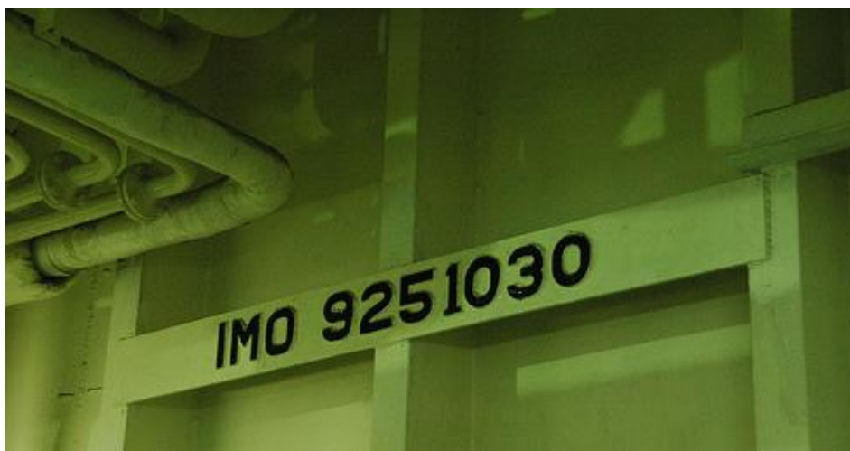
Figura 6 – Número de identificação IMO marcado em local da superestrutura
