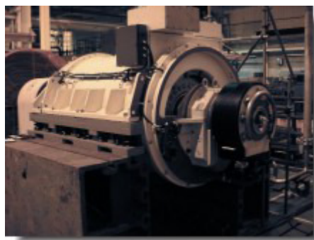
Figura 52: Motor HTSAC (5 MW – 230 rpm). Fonte 50
