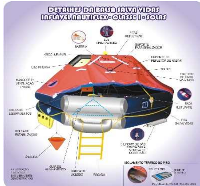
Figura 17. Ilustração de uma balsa salva-vidas e seus componentes
