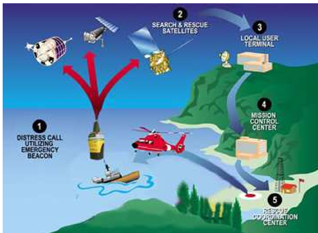
Figura 2. Funcionamento do EPIRB
