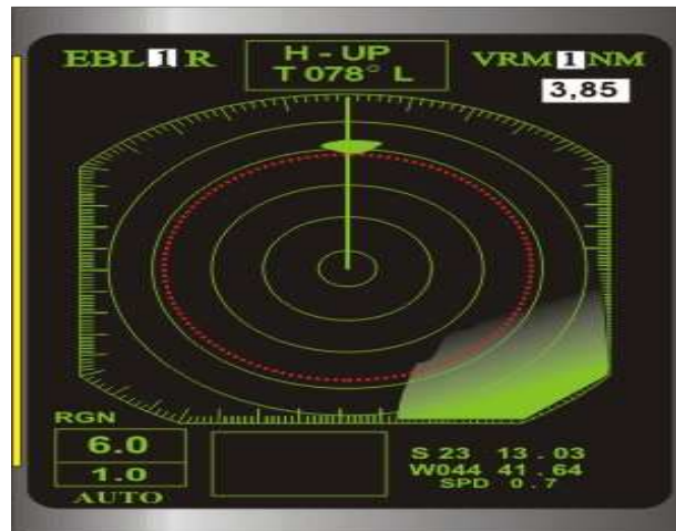
Figura 3. Apresentação em tela radar tipo ARPA
