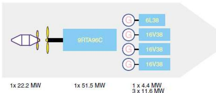
CRP do inglês é a abreviação de Contra Rotating Propellers. O propulsor ligado ao eixo convencional é responsável por direcionar um melhor fluxo de água de forma a fornecer mais energia para ser utilizada pelo propulsor traseiro.
