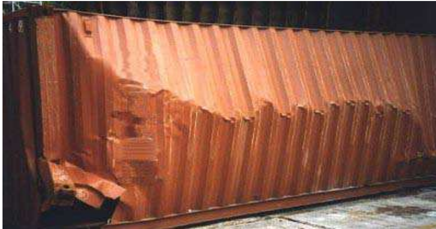
Figura 14: Contêiner bastante avariado pelo deslocamento da carga ovada
