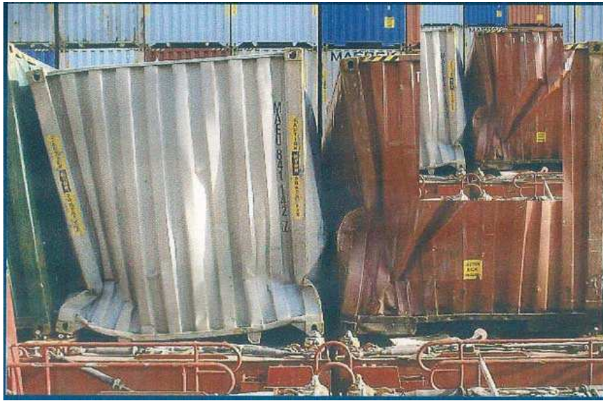
Figura 09: Contêineres totalmente deformados pela compressão causada nos montantes e anteparas frontais e laterais.
