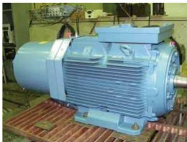
Fig 6 motor elétrico de corrente alternada
