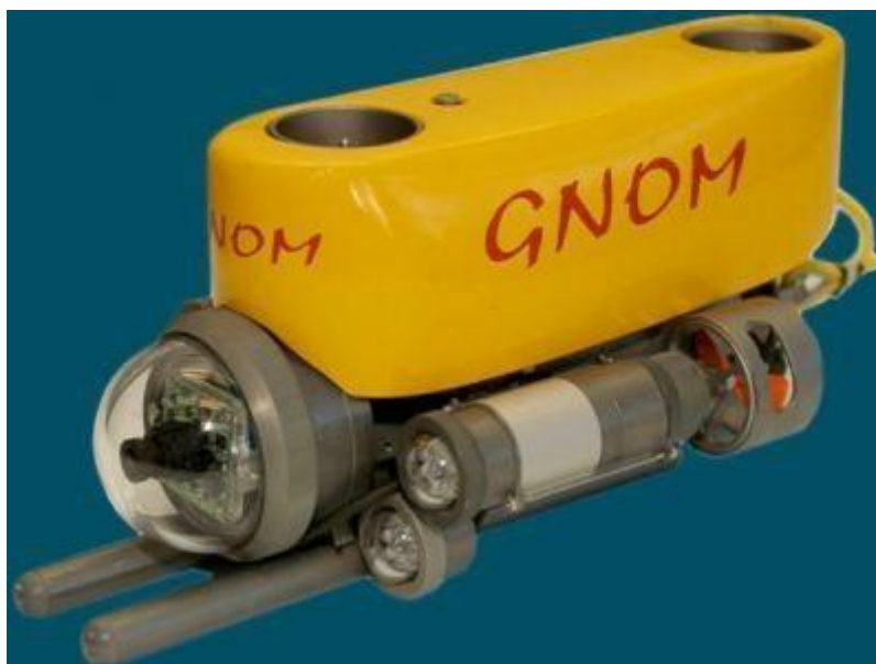
Figura I ROVs Gnom, robôs usados nas inspeções de casco
