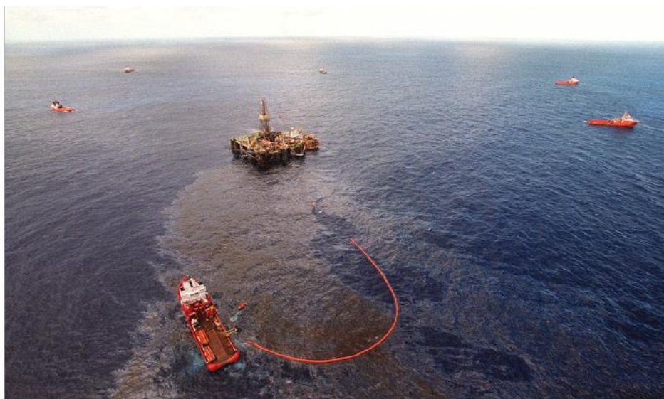
Foto 12 – Embarcação OSRV em operação de recolhimento de óleo.
