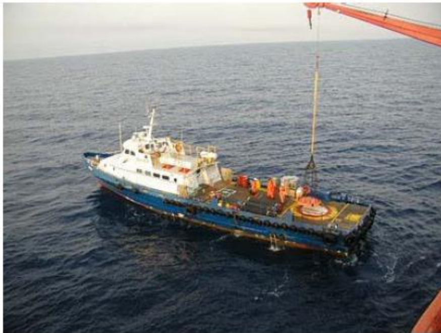
Foto 10 – Embarcação Crewboat em operação de transferência de tripulantes com a plataforma
