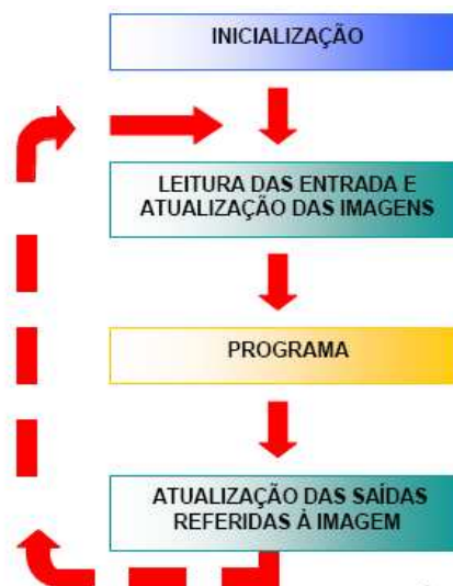
Figura 2 - Ciclo de processamentos do CLP
