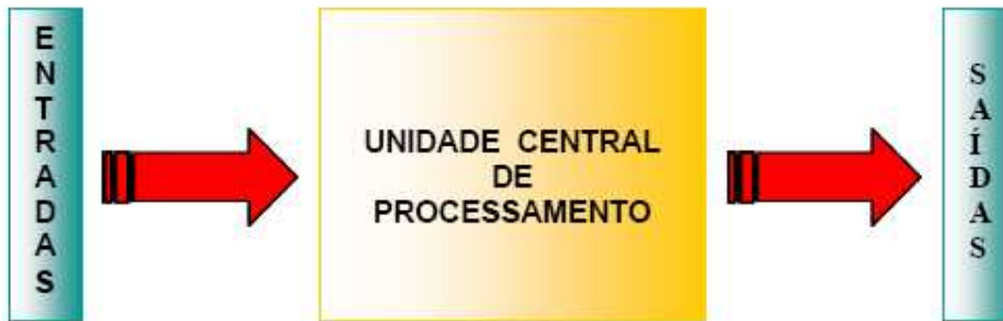
Figura 1 - Estrutura básica de um CLP
