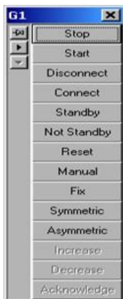
Figura 4: Menu suspenso de controle de operação do Gerador Fonte: Kongsberg Functional Design Document
