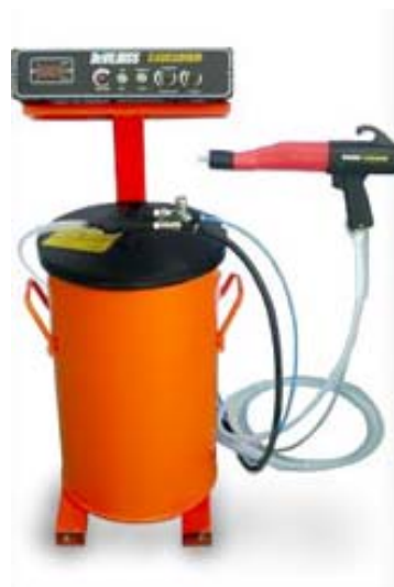
Figura 26 - Equipamento de pintura eletrostática
