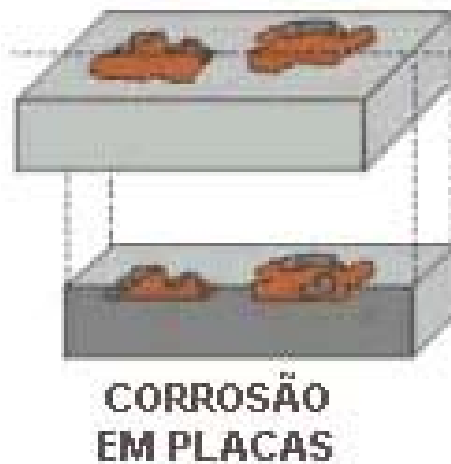
Figura 5 - Corrosão em placas Fonte – http://www.icz.org.br
