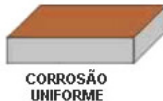
Figura 4 - Corrosão uniforme Fonte – http://www.icz.org.br
