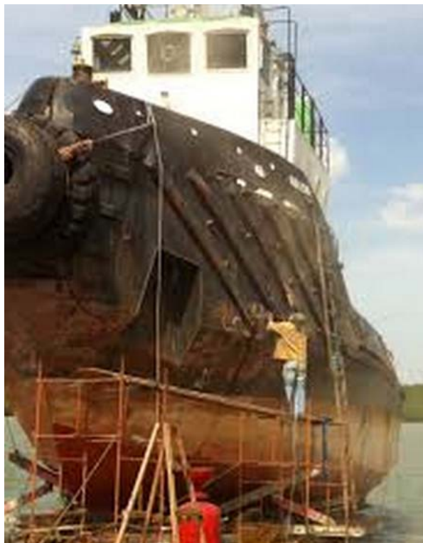
Figura 15 - Limpeza da superfície a ser tratada
