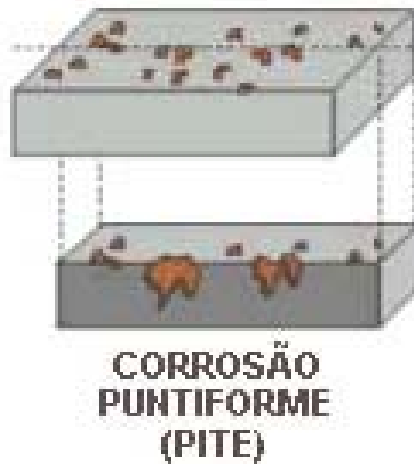
Figura 6 - Corrosão por pites Fonte – http://www.icz.org.br
