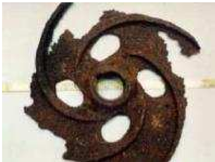
Corrosão Generalizada em Rotor de Bomba Submersa.
