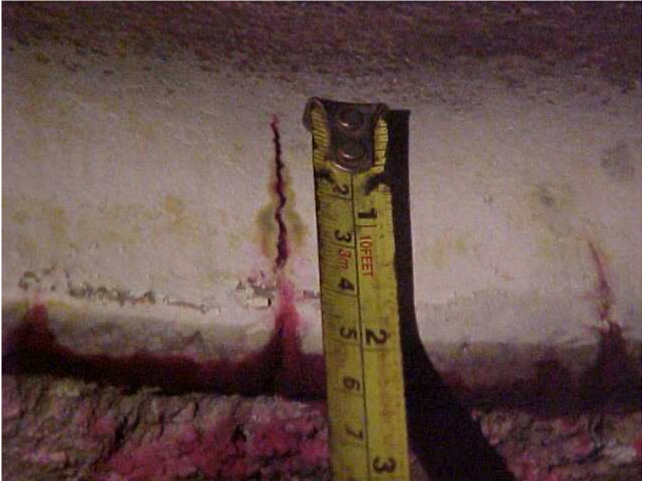
Fadiga Térmica – Fonte: Drew Ameroid Marine USA 1992
