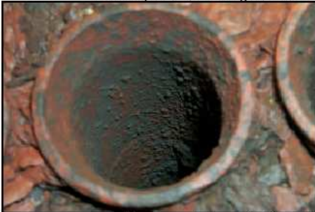
Presença de incrustação no lado interno dos tubos geradores
