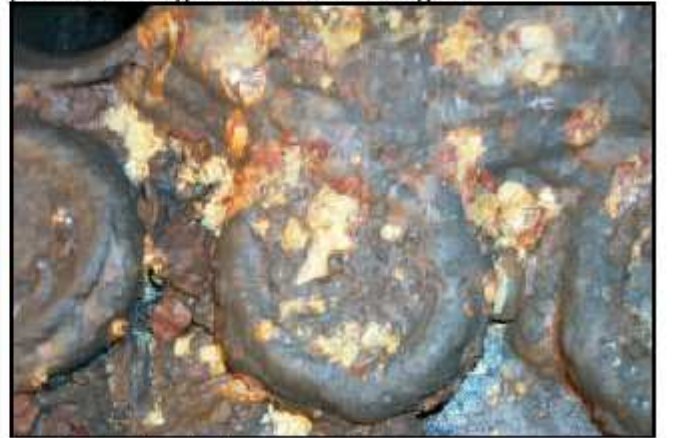
Presença de incrustação no lado interno dos tubos geradores
