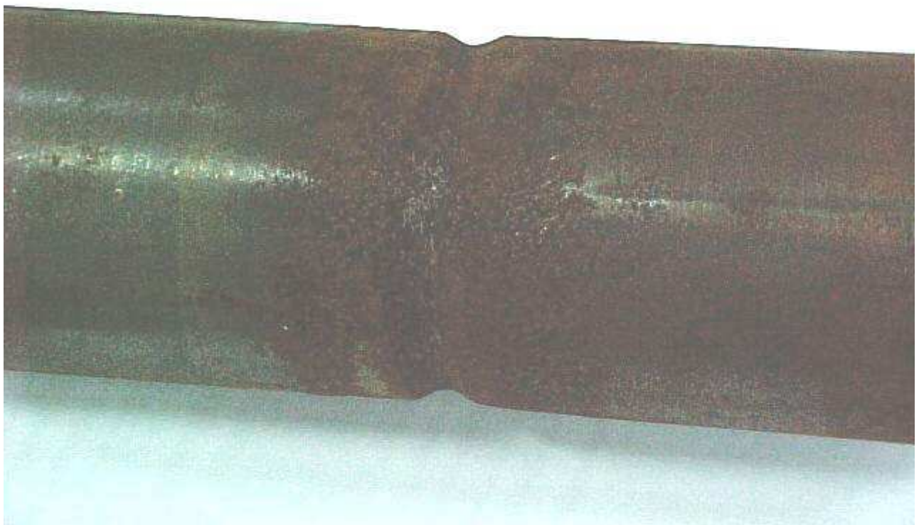
Desgaste de Tubos por Abrasão – Fonte: Drew Ameroid Marine USA 1992
