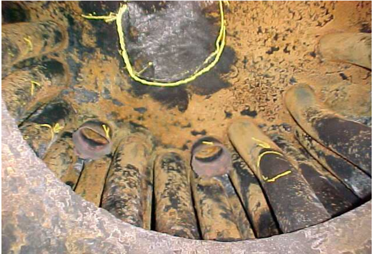
Flambagem e Oxidação Negra – Fonte: Drew Ameroid Marine USA 1992
