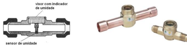
Figura 3.37 – Visor de líquido com indicador de umidade.
