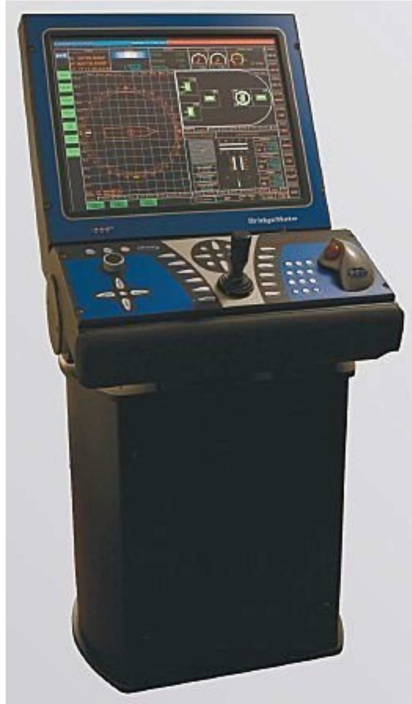
Figura 04 - Painel de operação de um sistema de posicionamento dinâmico para navios Fonte: Livro Texto – Automação do CIABA
