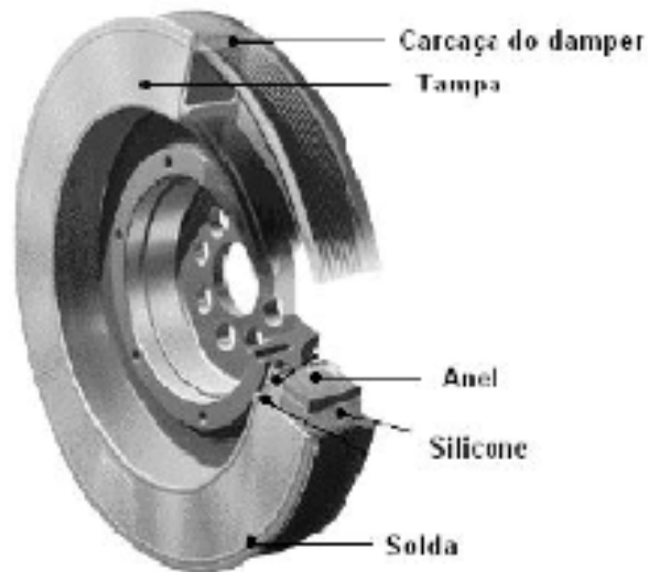
Figura 30 - Detalhe de um amortecedor de vibrações torcionais do tipo viscoso
