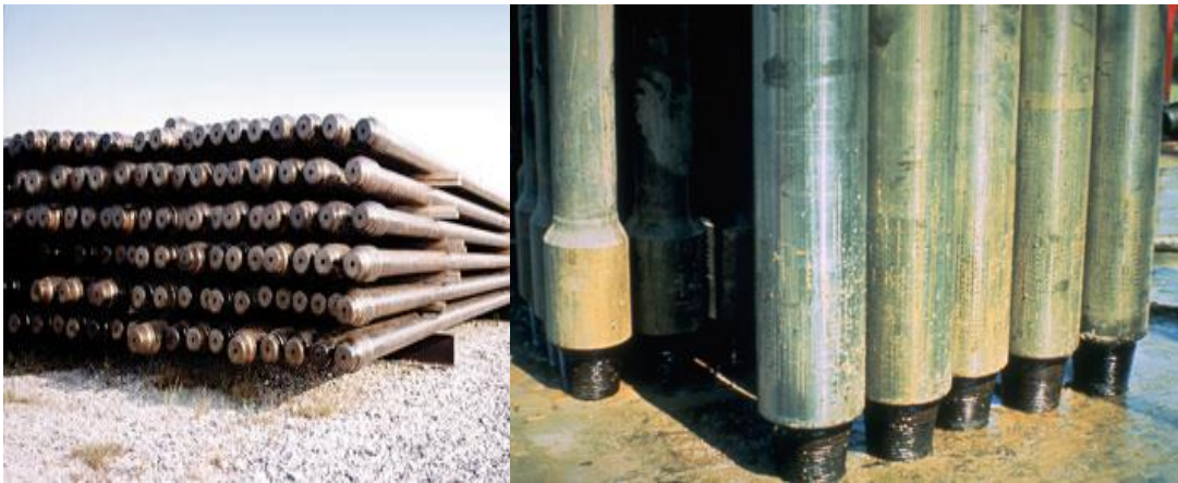
Figura 3.3 – Drill Pipes (Tubos de Perfuração)
