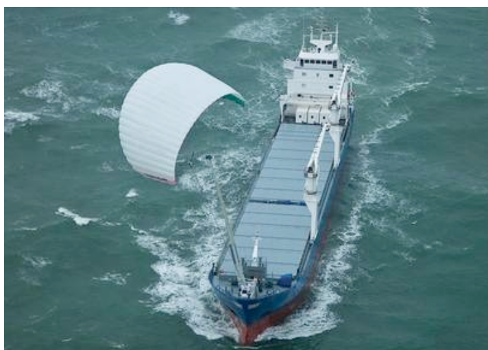
Figura 11. Pipa de reboque instalada no navio graneleiro “Aghia Marina”
