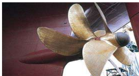
Figura 24: Exemplo de CRP Hélices Contra rotativas. Fonte: www.naval.com.br
