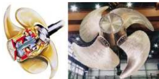
Figura 5: Exemplo de propulsor de passo controlável. Fonte: www.schottel.de/marine-propulsion .
