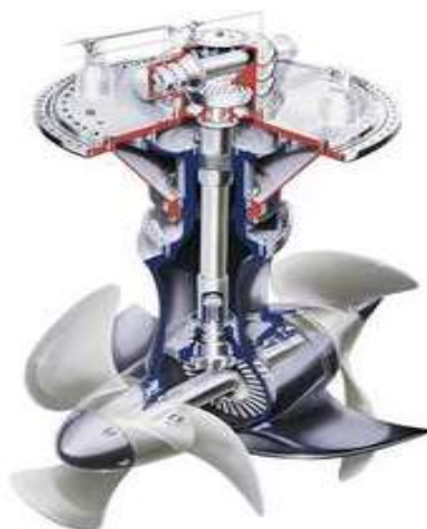
Figura 21: Propulsor azimuthal com duplo hélice. Fonte: http://www.schottel.de/marine-propulsion .
