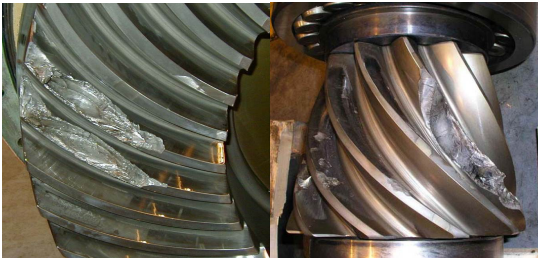
Figura 20 "Gear Box" danificada
