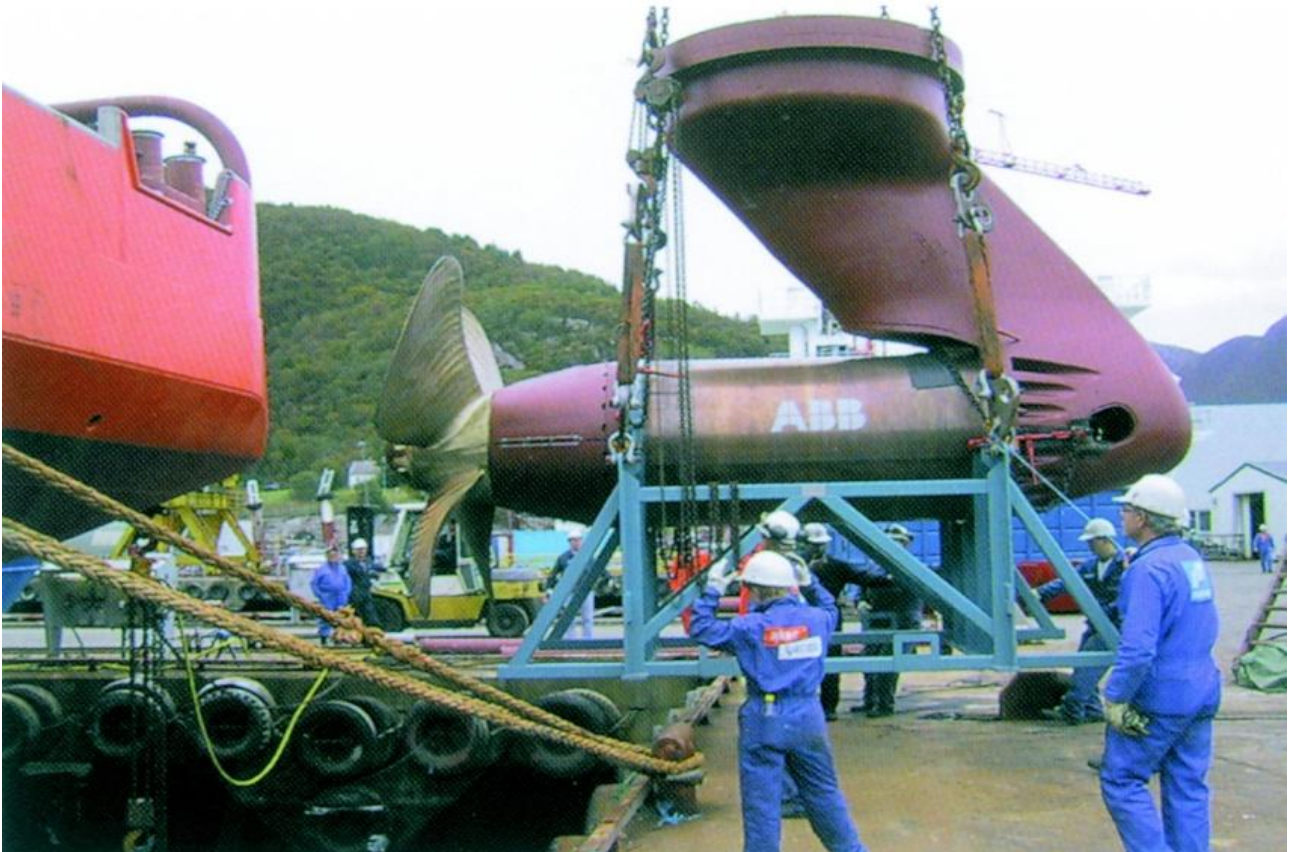
Figura - Azipod sendo instalado no Normand Rover. Primeira embarcação offshore a receber o propulsor Azipod. Entregue em novembro de 2001.
