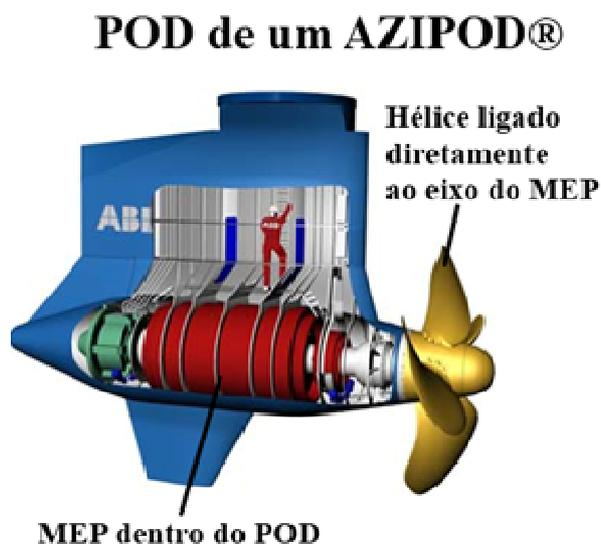
Cada azipod é alimentado por corrente alternada, que então é retificada para corrente contínua e logo depois é enviada a um inversor, onde se torna alternada
