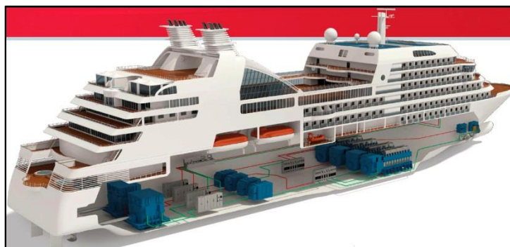
Fig.1:Esquema de um navio com propulsão elétrica e acionamento do hélice por linha de eixo
