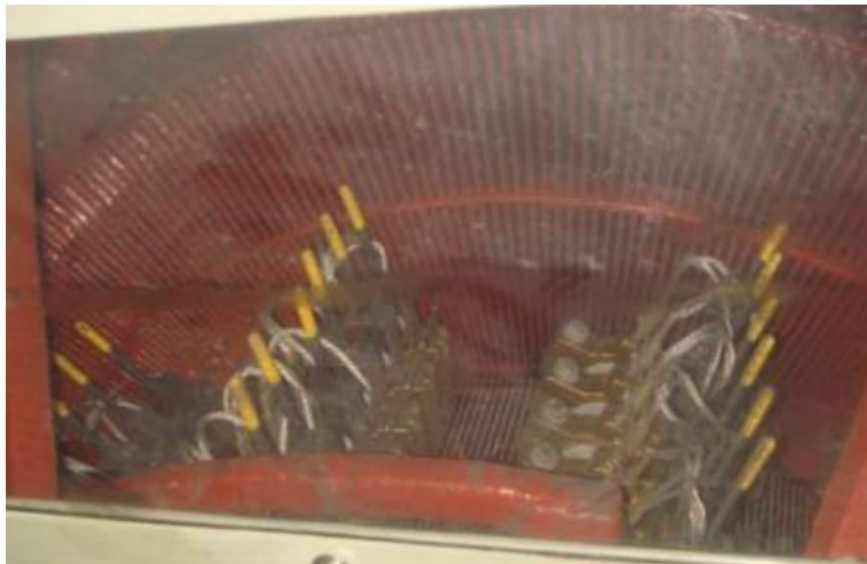
Figura 15: Motor Elétrico (CC) com visão dos coletores de teclas e suas escovas.
