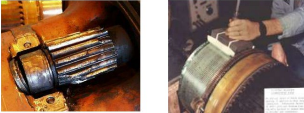
Figura 17: Motor elétrico com avaria no coletor (esquerda) e deposição de liga de níquel nas teclas de um coletor (direita).
