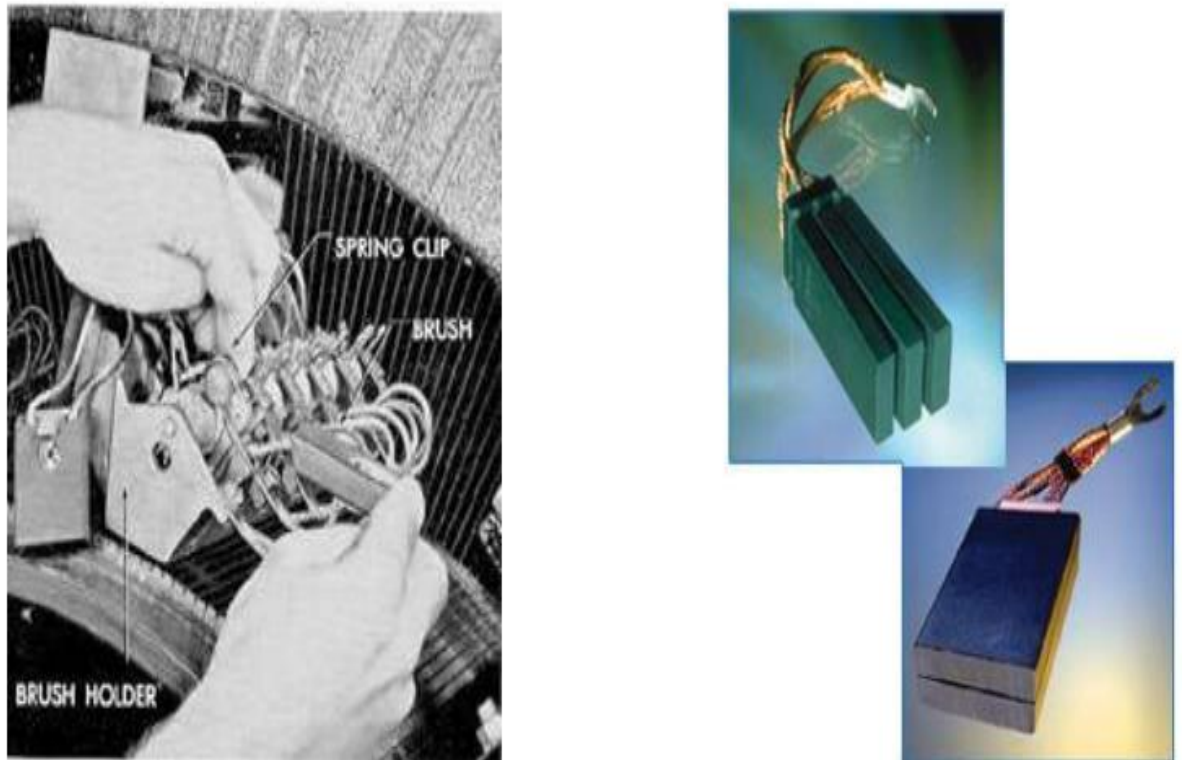
Figura 12: Coletor e escovas de um antigo motor elétrico em CC.
