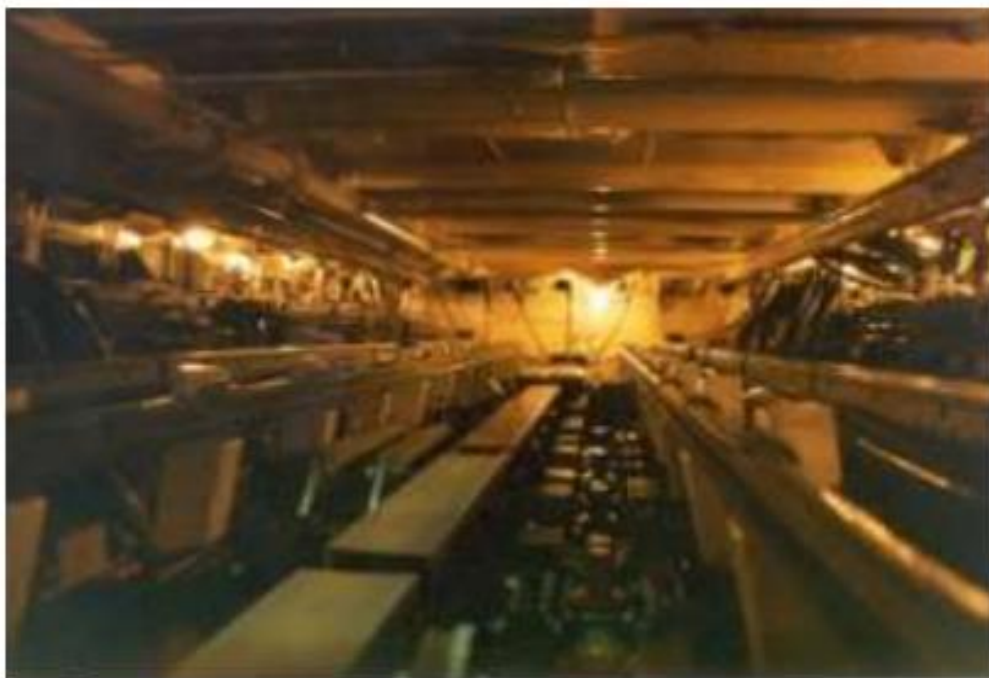
Figura 9: Praça de baterias de um submarino.
