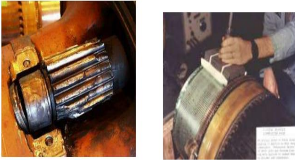
Figura 13: Motor elétrico com avaria no coletor (esquerda) e deposição de liga de níquel nas teclas de um coletor (direita).
