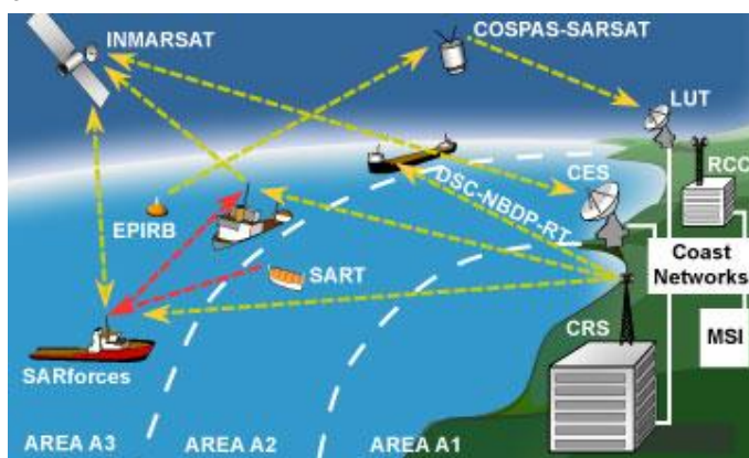
Fig 14: Conceito geral do Sistema INMARSAT, em conjunto com COSPAS-SARSAT e EPIRB
