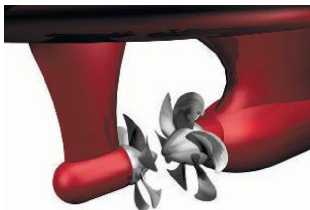
figura 4- Propulsão CRP Azipod
