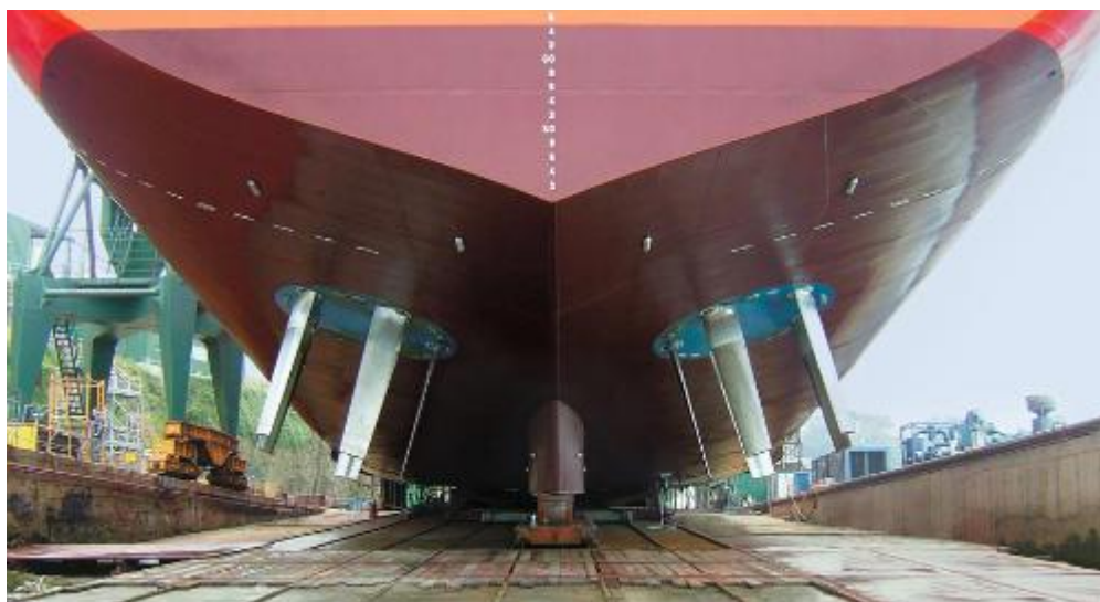
figura 7- návio com propulsão voith schneider
