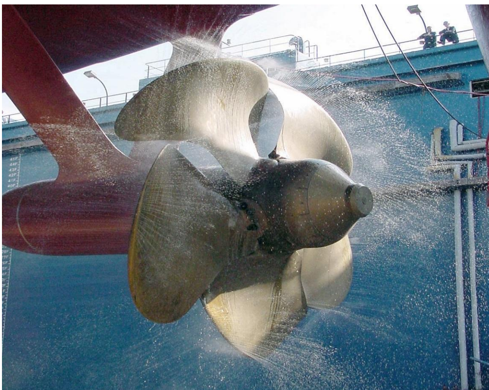
figura 10- Hélice de passo variável da Schottel.
