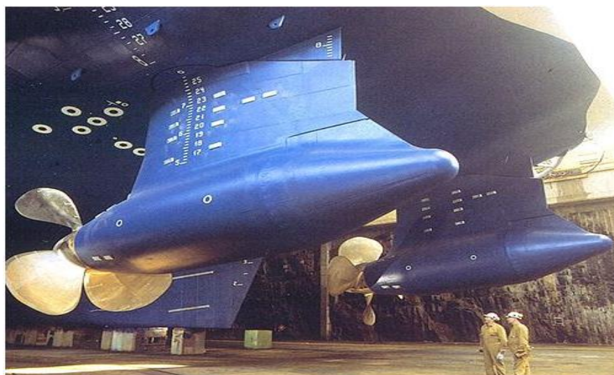
figura 3- Propulsão Azipod dupla
