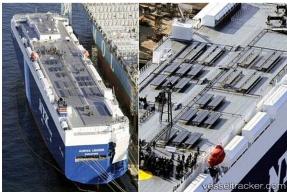
Figura 14: Navio Auriga Leader equipado com 328 painéis fotovoltaicos, extraído de www.vesseltracker.com .
