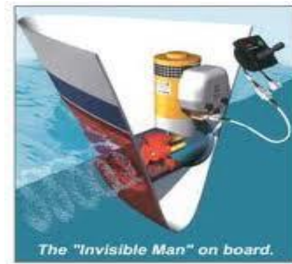
Figura 8 Ilustração de um Sistema Bow Thruster e seu comando
