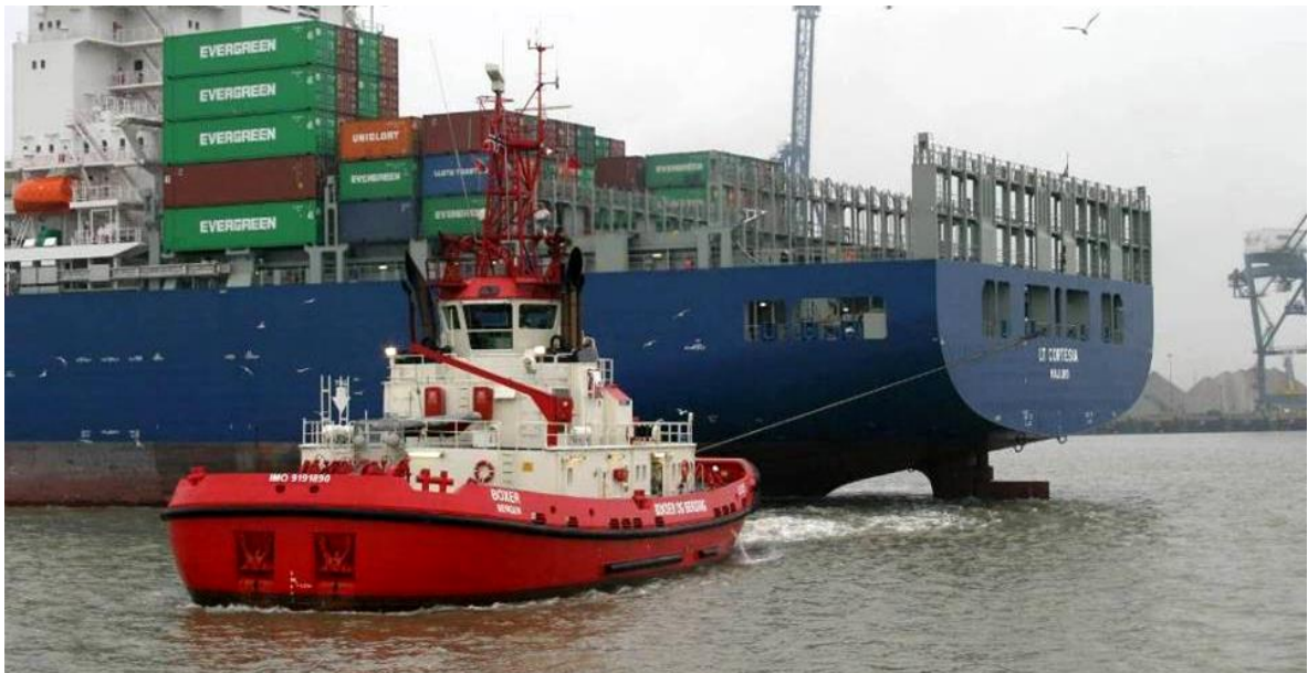
Figura 15 Ilustração de um navio sendo rebocado pela popa por um rebocador Voith .
