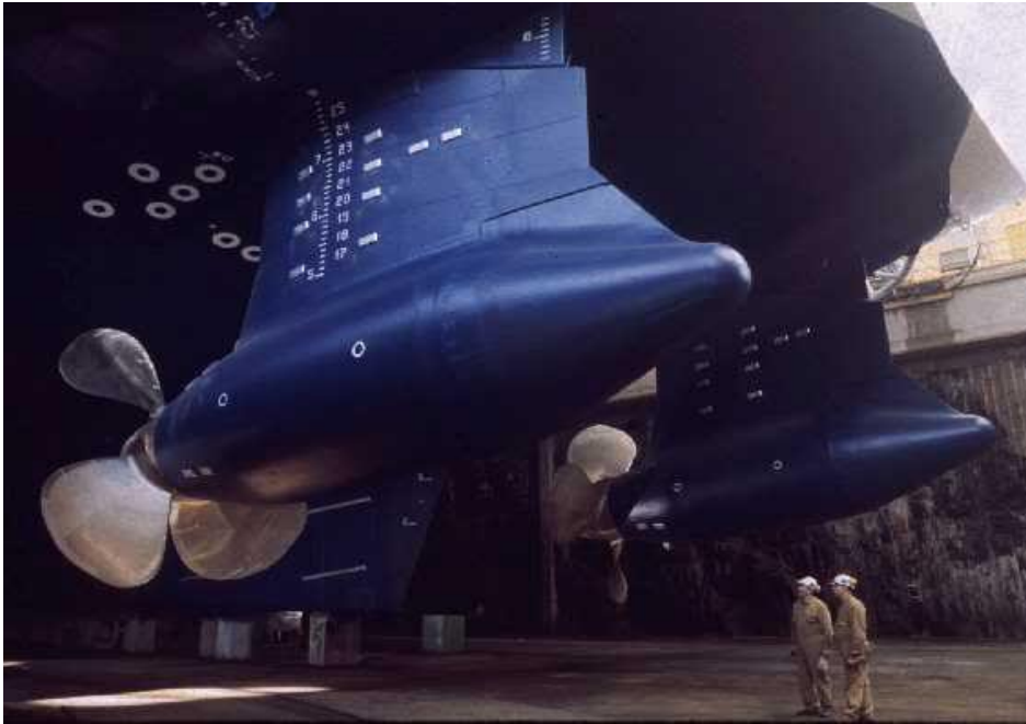
Figura 3 Exemplo de Azimuth Pulling Propeller de uma embarcação
