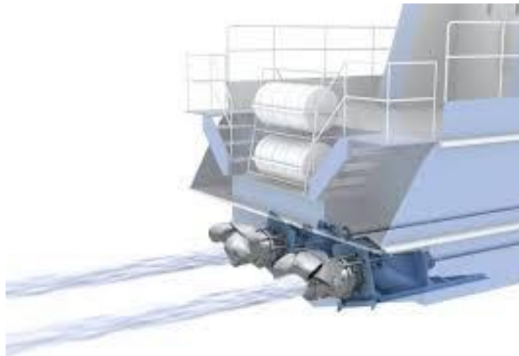
Figura 10 Ilustração de um propulsor Jato Bomba e seus “falps” que direcionam o fluxo da água para traz, para os bordos ou para frente.
