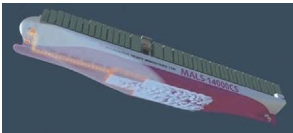
Figura 24 - Lubrificação por ar.
