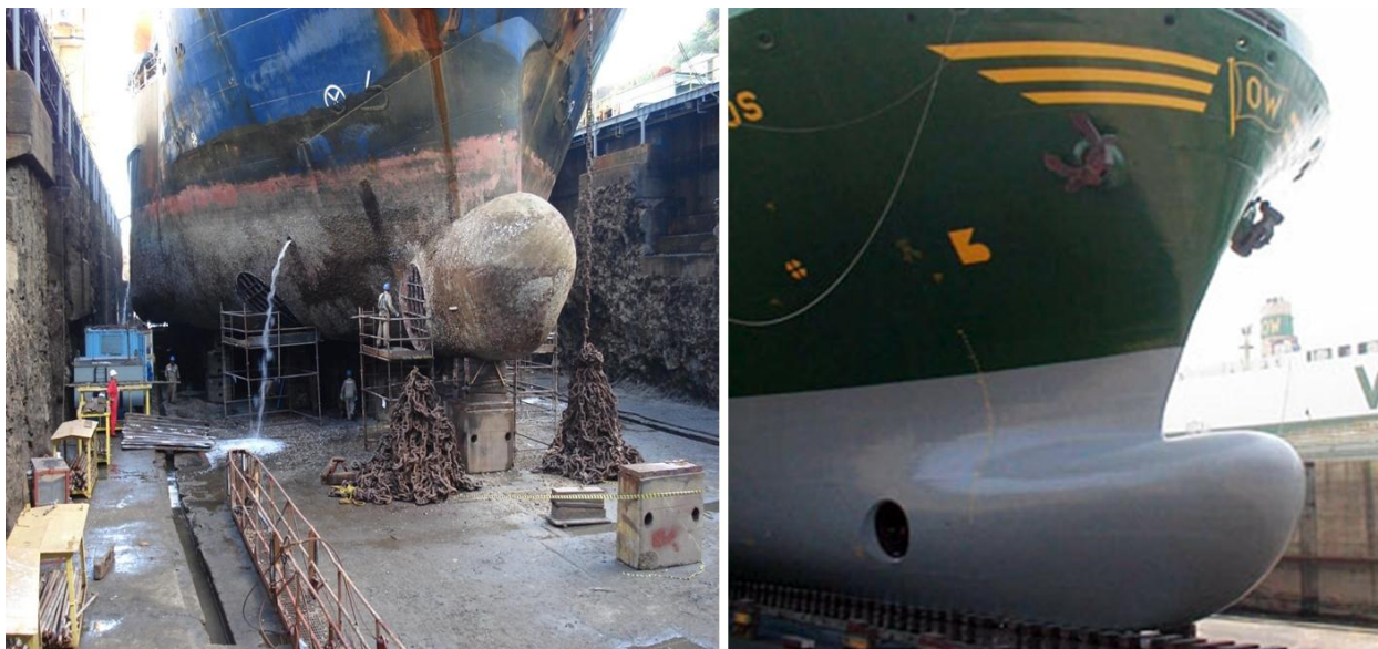
Figura 27 - Redução da rugosidade do casco.
