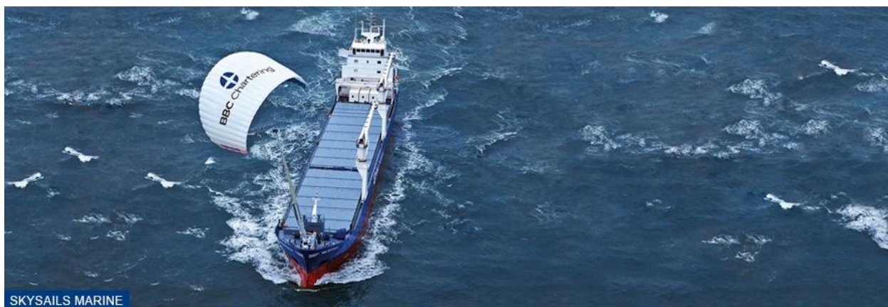
Figura 30 - Sistema SkySails sendo usado em um navio.
