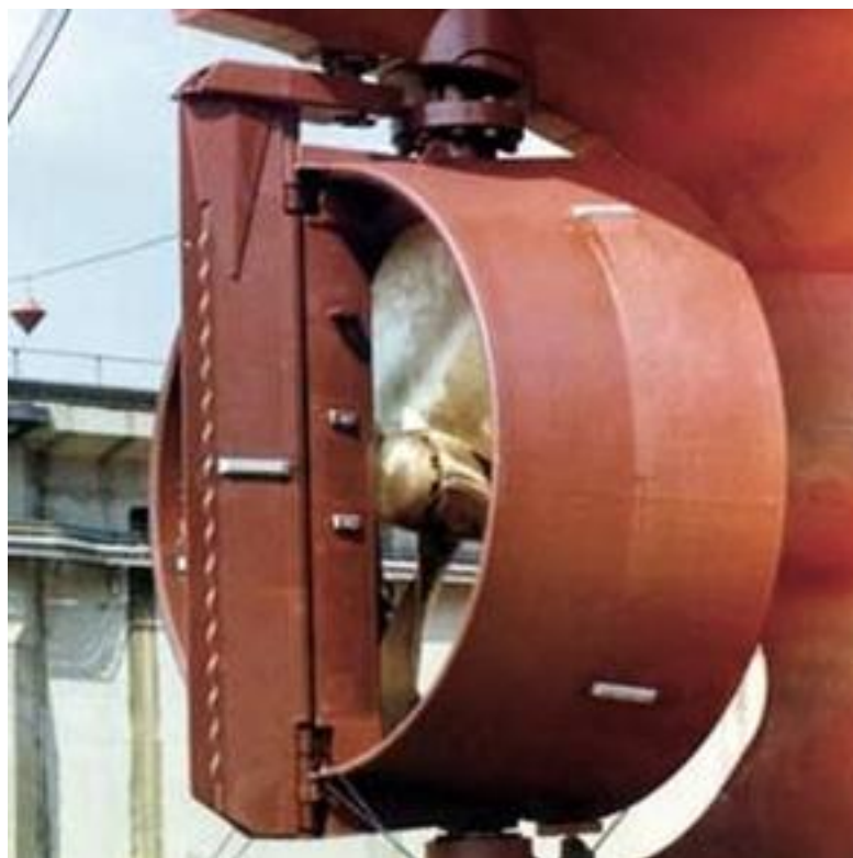
Figura 14 - Propulsor em duto.
