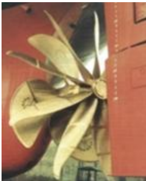
Figura 12 - Volante Grim Vane.
