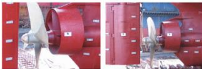
Figura 25 – Duto Mewis depois de instalado
