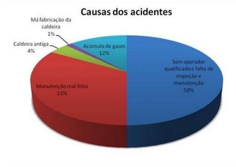
Figura 15 – Causa dos acidentes com caldeiras
