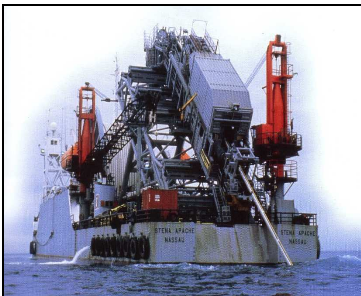
Figura 10: Embarcação monolinha lançando dutos rígidos.
