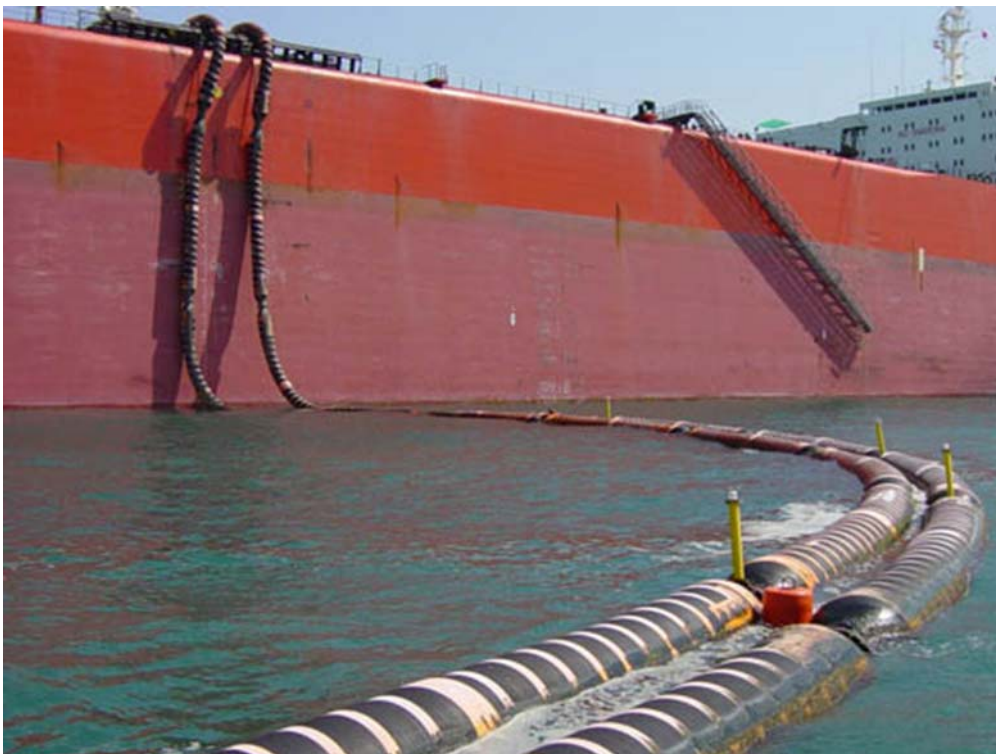
Figura 26 – Operação de offloading com linha flutuante(DUNLOP OIL MARINE)
