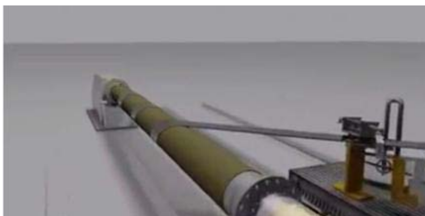
Figura 19 – Assentamento das camadas de fibras poliméricas(FLEXOMARINE,2010) .
