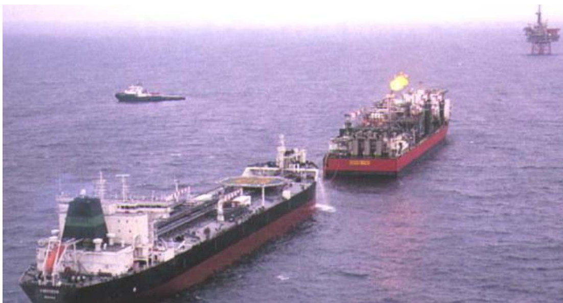
Figura 2 – FPSO ao realizar operação de offloading com um Aliviador (TEXACO,2001)
