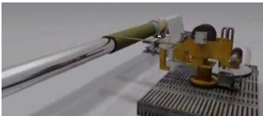
Figura 18 - Revestimento da camada de liner(FLEXOMARINE,2010)
