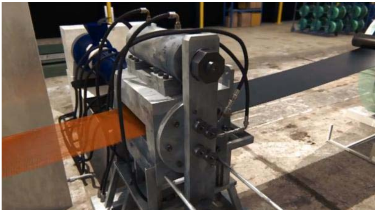
Figura 16 – Confeção das camadas compostas poliméricas para reforço, o "coating" (TRELLEBORG,2011)
