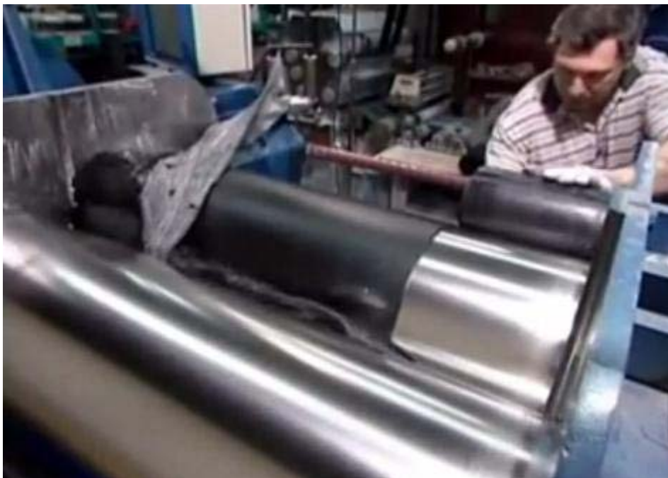
Figura 14 - Moedor da borracha bruta(PREMIER RUBBER CO,2012)
