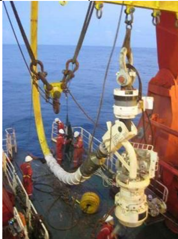
Figura 35 - Linha flexível apoiada na mesa de trabalho.
