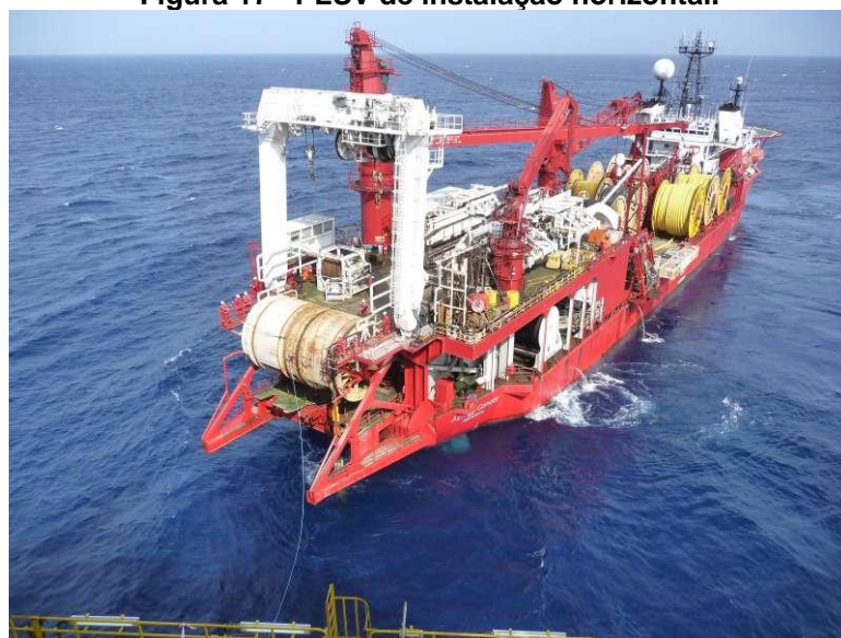
Figura 17 - PLSV de instalação horizontal.
