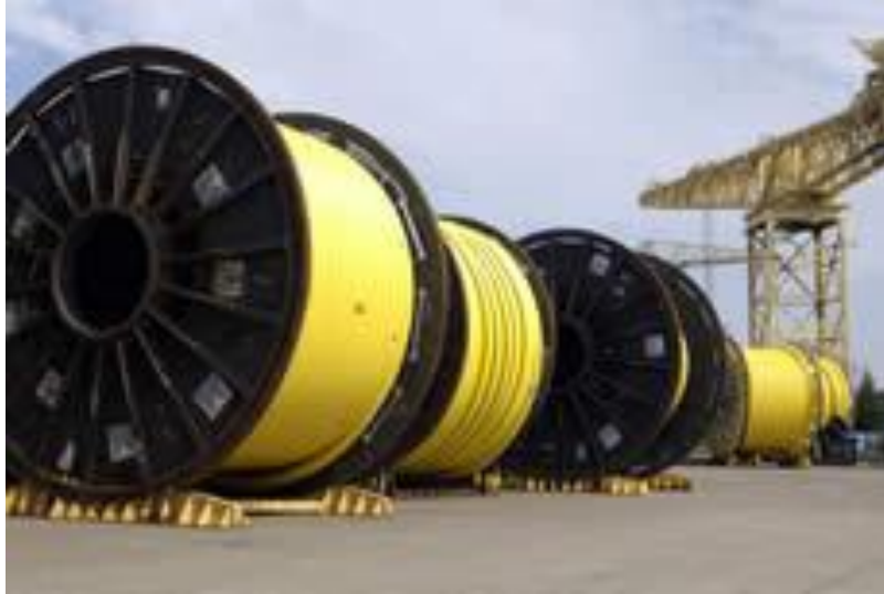
Figura 13 - Duto acondicionado em bobina.
