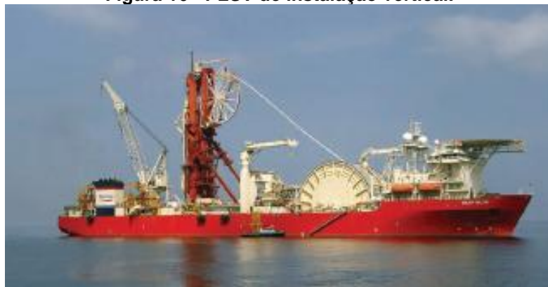
Figura 16 - PLSV de instalação vertical.
