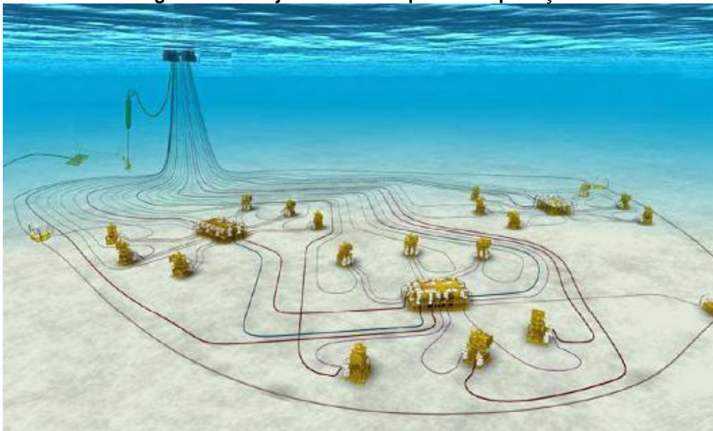
Figura 1 - Arranjo submarino típico de exploração.
