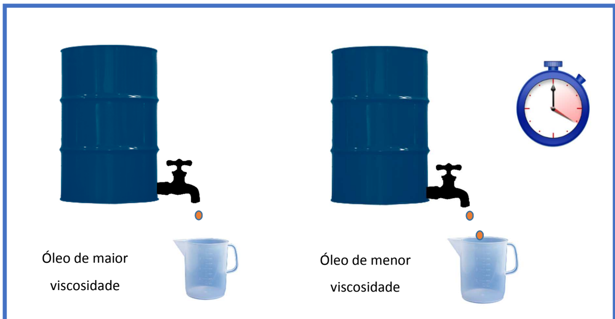
Figura 14 - Métodos utilizados para determinar a viscosidade verificando o tempo gasto para escoar determinada quantidade de óleo
