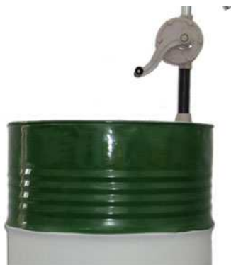
Figura 62 - Bomba manual instalada no tambor de óleo
