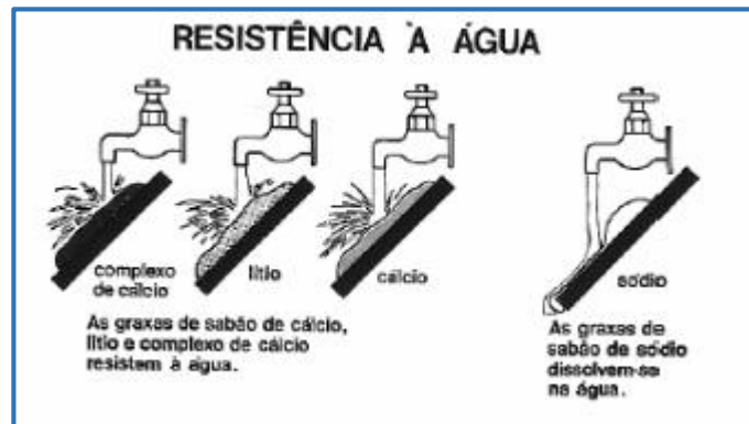
Figura 2- Graxas sabão de cálcio, lítio e complexo de cálcio, resistem a água.
